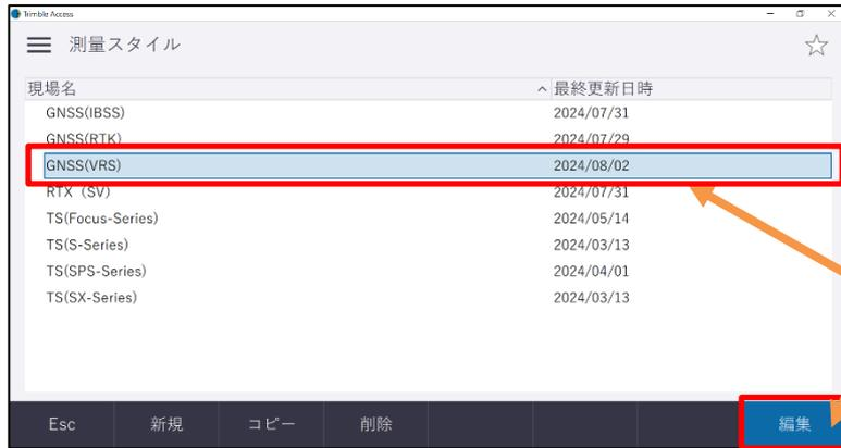
GNSS(VRS)観測スタイルの設定（配信会社／ユーザー名／パスワードの設定）が完了したら、以下の手順で設定を変更してください。
