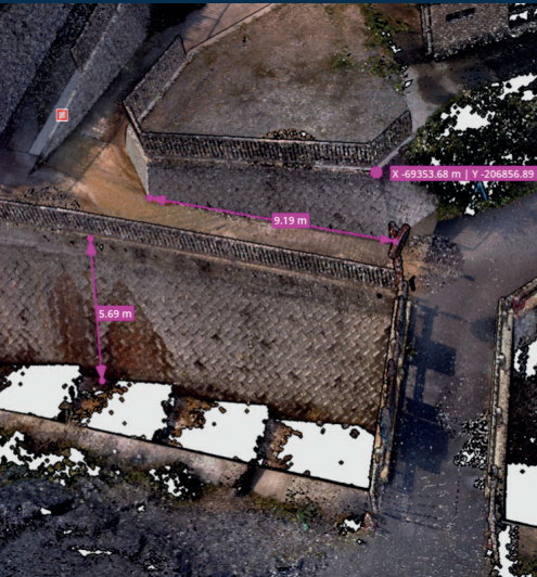
リアルタイムに点群データを確認
