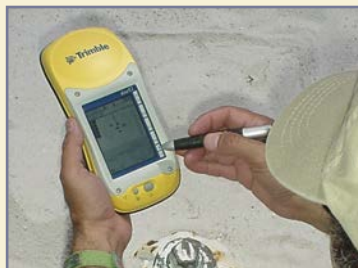
消火栓のGPS位置を記録
