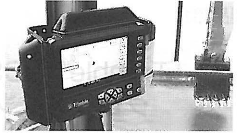
写真2 モニター、縦断表示
