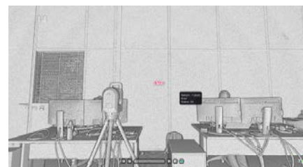
X9：マアレ（干渉縞）が低減し点群の品質が向上
