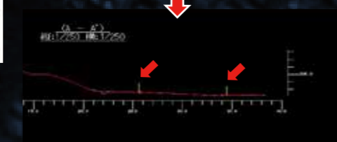
作図した断面図に配置された「ガードレール」の位置を示す立ち上がり線
