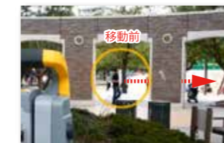
Trimble Sシリーズが途中で障害の有る壁の向こう側のプリズムを追尾中
