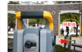
障害を通過した後もTrimble Sシリーズはプリズムをすばやくキャッチ (一瞬ロストするが即座に追尾開始)
