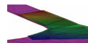
0.2m上方向にオフセットした面の一部。事前にクリッピング領域 (Clipping boundary) を作成しておくことで、面の一部だけのオフセットが可能となる
