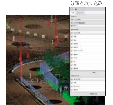
地面や仕切（フェンス）、中植生、高植生に分類した点群
