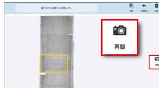
再撮影したい場所の隣接フレームを選択し再開することで、自己位置から再撮影場所を見つけやすくなります。直後に再撮影を行えることで、現場戻り作業（再撮影）が大幅に軽減されます。
