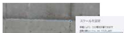
画像上の 2 点を指定し、実寸値を入力することでスケールを付与。スケールに合わせてひびの自動解析を開始
