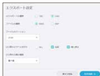
ひびの形状はCADデータとして出力リストもCSV形式で出力
