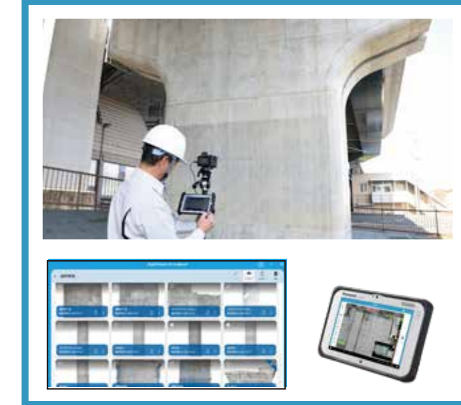
ピンボケやブレがある写真は赤い枠で表示します。内容を確認後削除しその部分の再撮影がすぐに行えます。
